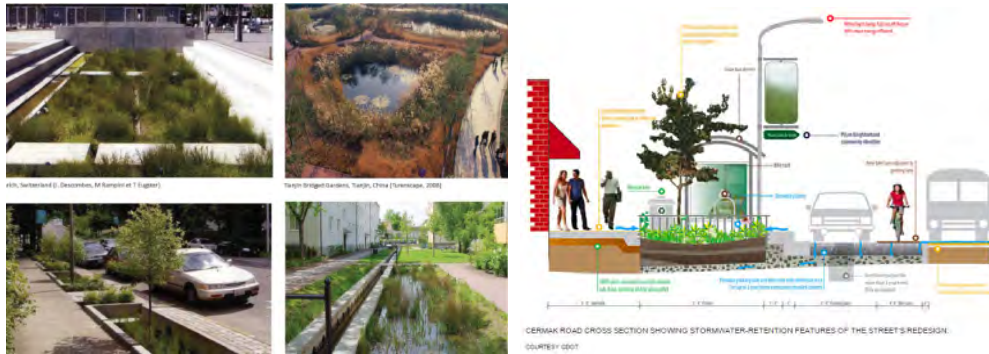
Figuur 74: a) Waterberging tussen twee drempels en trottoir, volume waterretentie is afhankelijk van trottoirhoogte. B) Holle straat systeem met product 'Granudrain' infiltratiestrook in het midden van de straat. c) Groene infiltratiestroken langs wegen integraal ontwerp in straatprofiel: hemelwater wordt naar deze stroken afgevoerd, waarna het water kan infiltreren in de grond.
