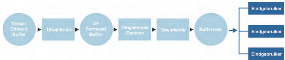
Figuur 68: stappen drinkwaterproductie via UF-RO
