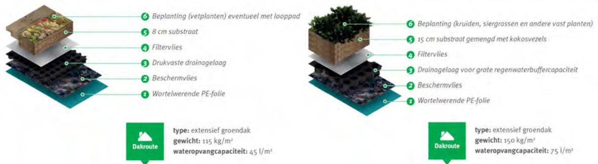
Figuur 77: Extensief groendak (links) en semi-intensief groendak (rechts). Bron: Stad Antwerpen – Ecohuis. Deze voorgestelde types zijn weerhouden als respectievelijk minimum en maximum bij de berekening van kostprijzen (zie verder). Andere types met andere opvangcapaciteiten en gewicht zijn ook nog mogelijk.
