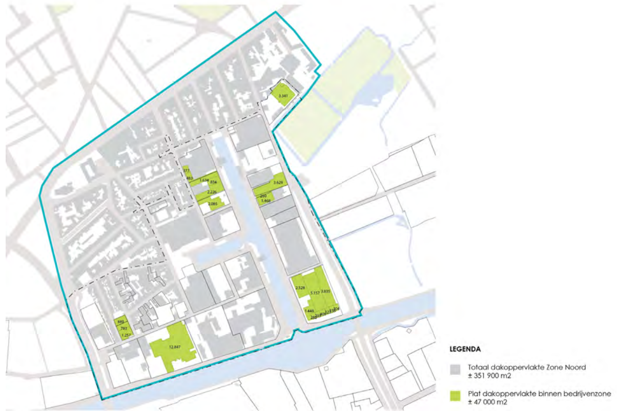
Figuur 83: Inventarisatie geschikt plat dakoppervlak voor groen dak.
